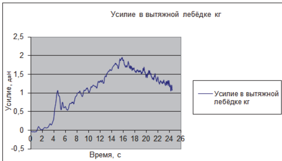
Диаграмма усилия при выборке полного мешка (массой 2,5 кг) на установке с минимальным углом наклона слипа и высоте h=600 мм
