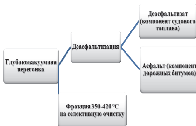
Рис. 3. Вариант № 3 переработки астраханского газоконденсатного мазута
