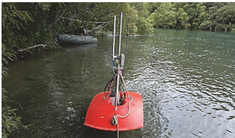
Рис. 1. Автономная гидроакустическая станция
