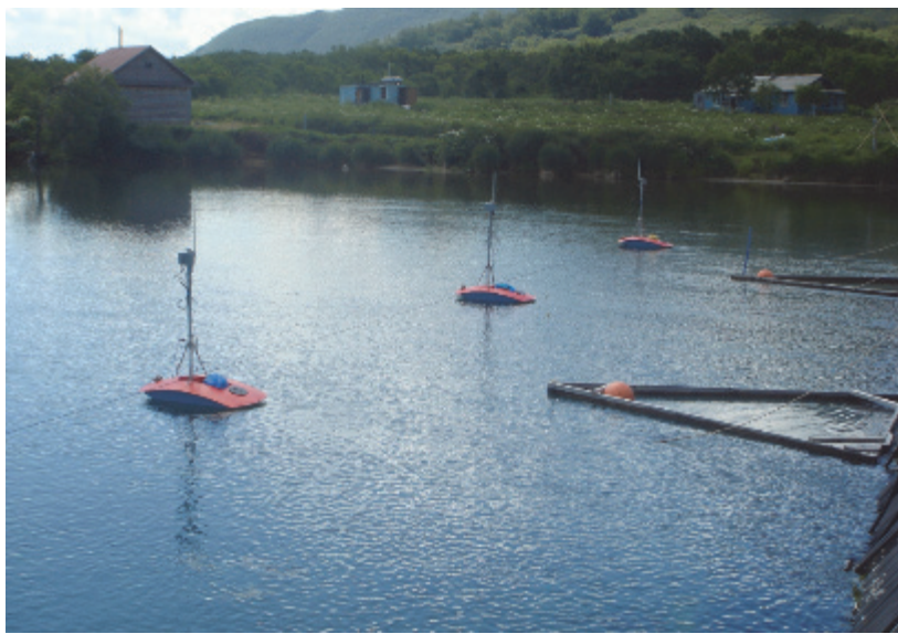
Рис. 2. Расположение автономных гидроакустических станций комплекса «NetCor» у рыбоучетного заграждения на р. Озерная (2010 г.)
